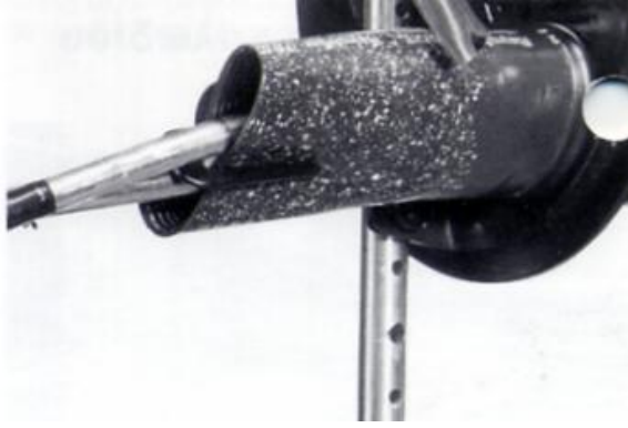
Σχήμα B11.16 Θέρμανση θερμοσυστελλόμενου σωλήνα
