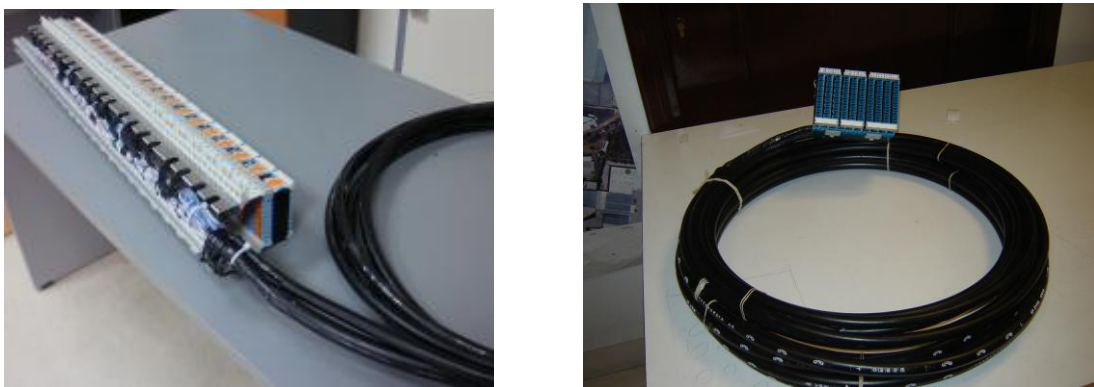
Σχήμα Α9.2.4β Προκαλωδιωμένα στοιχεία τερματισμού ΚΔ (300 ζεύγη σε monoblock 5 στοιχείων MDF splitter) και ΑΔ (50+100 ζεύγη σε BRCP-HD 160 ορίων) για χρήση σε καμπίνα Γ3.
