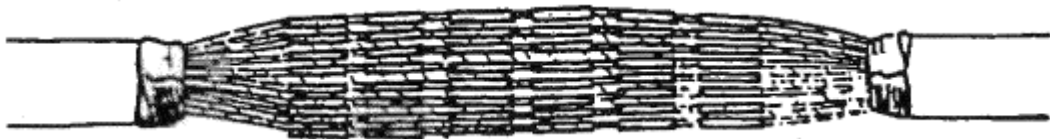
Σχήμα Β3.11 Εικόνα συνδεδεμένων καλωδίων μετά το τέλος της πλέξης
