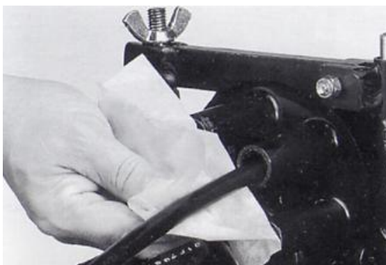
Σχήμα B11.37 Καθαρισμός στρογγυλής εισόδου
