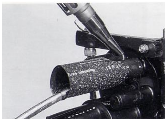
Σχήμα B11.40 Συρρίκνωση του θερμοσυστελλόμενου σωληνίσκου
