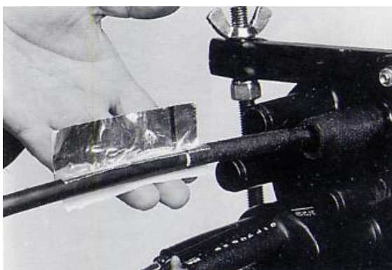
Σχήμα B11.39 Τοποθέτηση των φύλλων αλουμινίου
