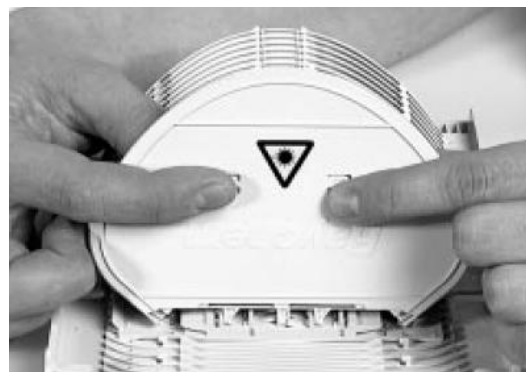
Σχήμα Β11.22 Τοποθέτηση καλύμματος σε οργανωτήρες κορμού και πρόσβασης
