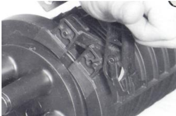
Σχήμα B11.30 Χρήση του κλείστρου για κλείδωμα του περιβλήματος
