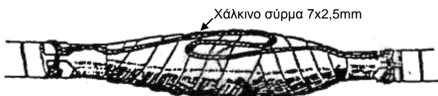
Σχήμα Β3.5 Εξασφάλιση ηλεκτρικής συνέχειας οπλισμού στον σύνδεσμο.
