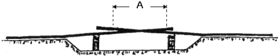
Σχήμα Β3.3 Άνοιγμα καλωδίων και αφαίρεση μανδύα.
