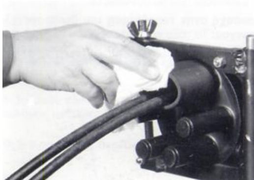
Σχήμα Β11.10 Καθαρισμός της οβάλ εισόδου
