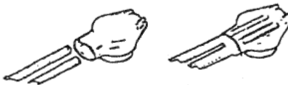
Σχήμα B3.22 Εισαγωγή άκρων αγωγών στον συνδετήρα
